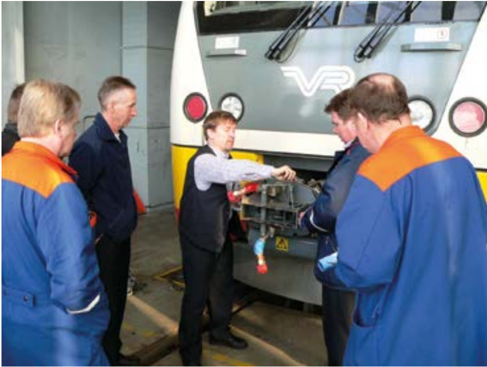
Jokaiseen veturityyppiin ja junaan vaaditaan tyyppikoulutus. Kuvassa harjoitellaan apuvetolaitteen asentamista Dm12-moottorivaunuun Pieksämäellä. Keskellä vasemmalta Osmo Turpeinen, opettaja Jouni Kokkonen ja Ari Kosunen. Kuva: Markku Vauhkonen.
