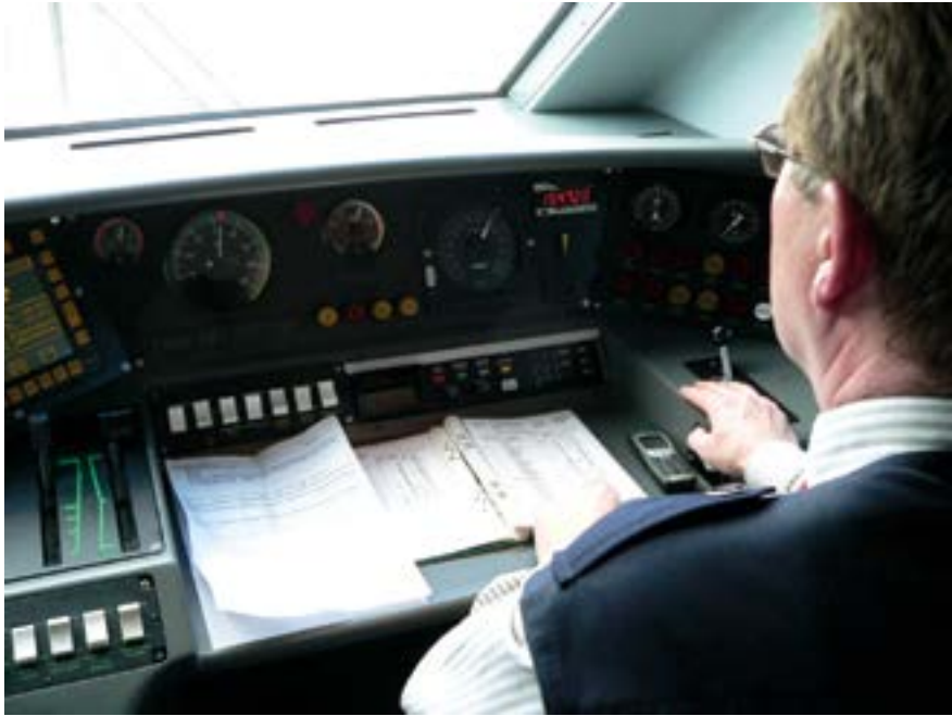
Pendolino-suurnopeusjunat otettiin Suomessa käyttöön vuonna 1995. Kuljettajien työympäristö muuttui uuden junakaluston myötä. Aikataulukirja oli jatkossa työvuorokohtainen. Tulostettava viikkovaroitus kertoi rataosan liikennöintirajoitukset ja -poikkeukset. Ohjaamon keskipaneelissa on kulunvalvontalaite, nopeus- ja jarrutusmittarit. Kehittyvä teknologia toi myös ylimääräistä kalustoa: pöydällä kuljettajan henkilökohtainen matkapuhelin. Kuva: Markku Vauhkonen.
