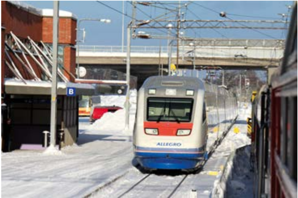
Matkustusmukavuuteen ja nopeuteen panostaminen ovat olleet VR:lle keinoja varautua henkilöliikenteen kilpailun avautumiseen. Smó eli Allegro on VR-Yhtymän ja Venäjän rautateiden yhteisesti omistama suurnopeusjuna. Rataverkkojen eri jännitteiden vuoksi junassa on kaksivirtajärjestelmä sekä molempien maiden kulunvalvontalaitteisto. Suomalainen kuljettaja ajaa junan yksin Vainikkalaan, josta se jatkaa venäläisten kuljettajien ohjaamana Pietariin. Kuvassa Allegro talvikoeajolla Pieksämäellä 2011. Kuva: Markku Vauhkonen.
